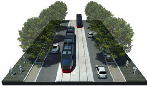
ทางวิ่งระดับดิน แบบกึ่งกลางถนน (Axle or Central Insertion)
